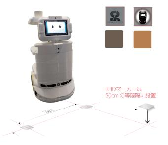
低コストでバックヤード等で動かしたい場合 安定・確実・安価なRFID版をおススメします 最小通路幅600mm(旋回する場合は750mm)と 狭い場所で動かせるのも魅力的
